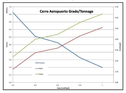
Figure 17.5 Cerro Aeropuerto Grade Tonnage Curve
